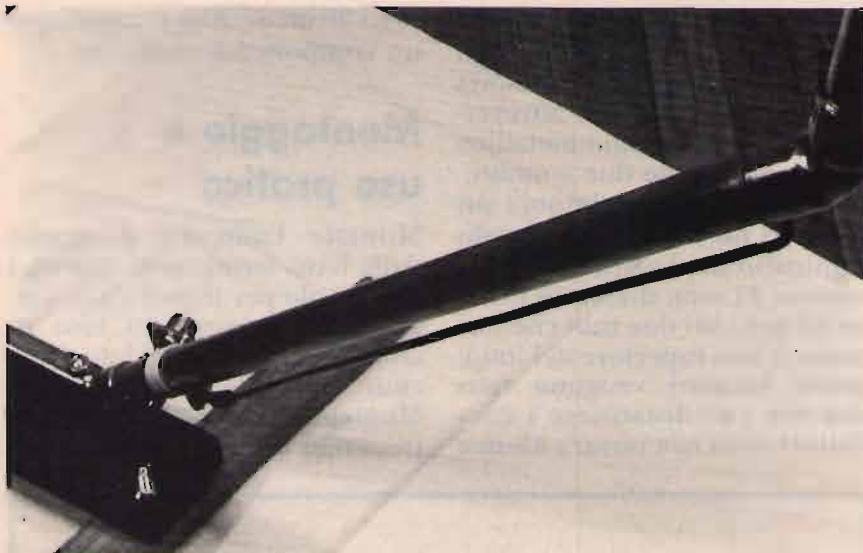
④ La base dell'antenna, con l'adattatore a gamma e il connettore coassiale SO-239.
